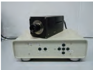
目指す耐放射線カメラのイメージ HEED撮像素子を搭載した監視カメラ
