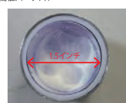
1.5インチ径のEu添加 \text{SrI}_2 単結晶 (東北大学)
