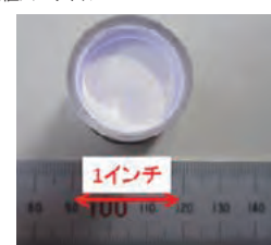
1インチ径のEu添加 \text{SrI}_2 単結晶 (東北大学)
