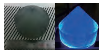
2インチ径 \text{SrI}_2(\text{Eu}) 単結晶 (C&A社)
