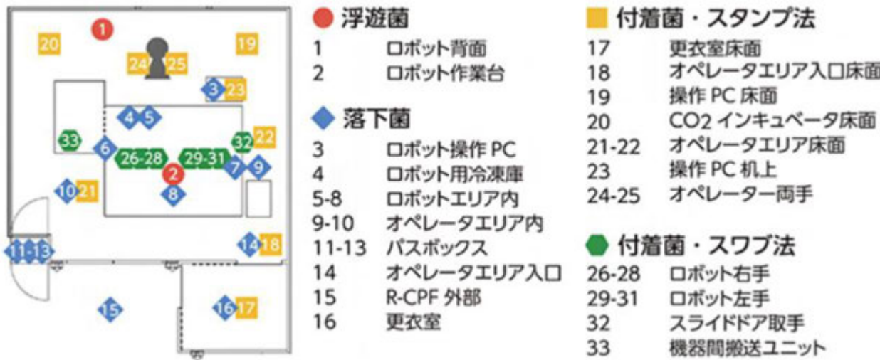
図3 浮遊菌、落下菌、表面付着菌のモニタリングポイント R-CPF内外の33地点において浮遊菌・落下菌・表面付着菌のモニタリングを実施した。表面付着菌の検出はスタンプ法(寒天培地に表面を接触させる方法)とスワブ法(表面を拭いとる方法)の2種類を用いた。
