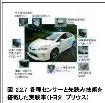
図 2.2.7 各種センサーと先読み技術を搭載した実験車(トヨタ プリウス)
