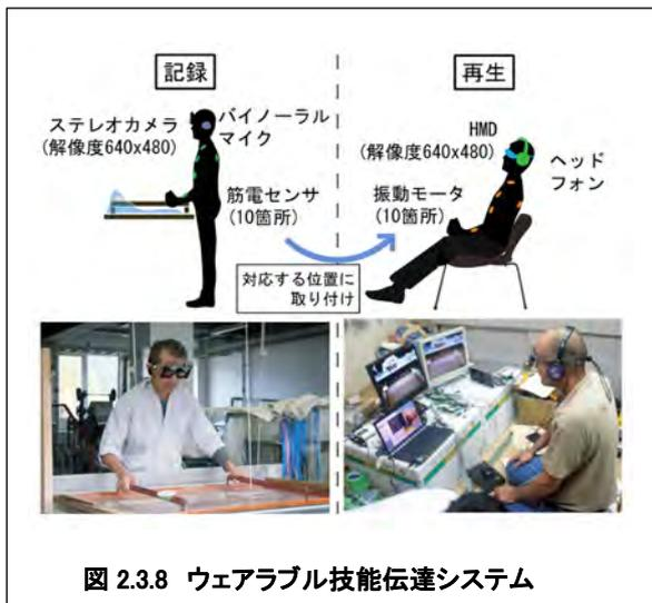
図 2.3.8 ウェアラブル技能伝達システム
