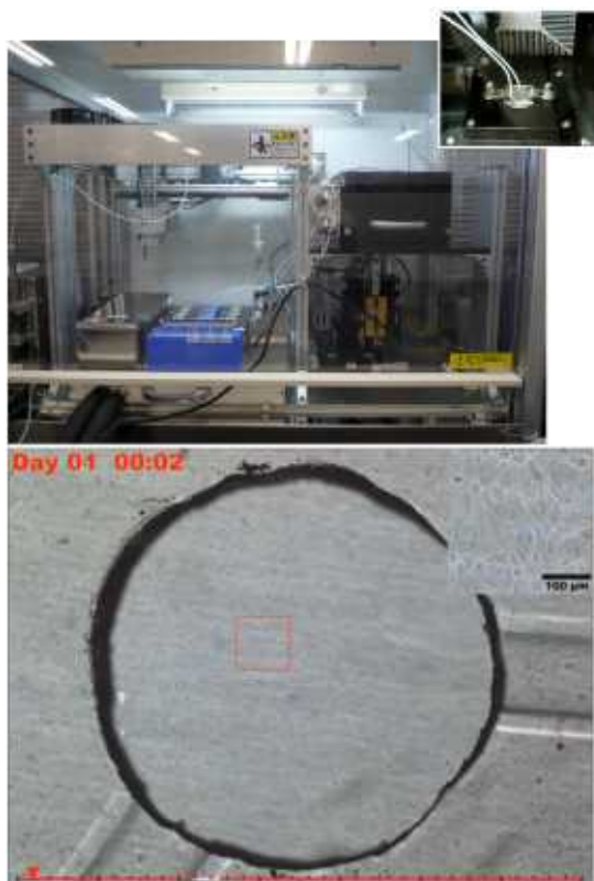
図9 チップ型培養装置の開発：上図がチップ型培養装置の全体像。左上に実際の細胞培養を行うチップ。このチップにて、約4週間、細胞を成熟させる。その際、本装置にて、培地交換、細胞観察を自動的に実施する。特に、容器内の細胞のほぼすべてを観察(下図)、画像解析することで、細胞の成熟過程を評価する。将来自己細胞を用いる網膜色素上皮培養の自動化のプロトタイプになり、本培養器の開発を通じて、網膜色素上皮細胞の製造に関する多くのノウハウを獲得できた。
