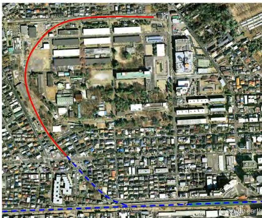
図 14 試作ケーブルが敷設される鉄道総合研究所内のループ線
