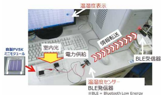
室内光独立電源を実装した温度度センサーの動作確認試験
