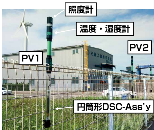
試作した円筒形太陽電池(色素増感型)の性能試験
