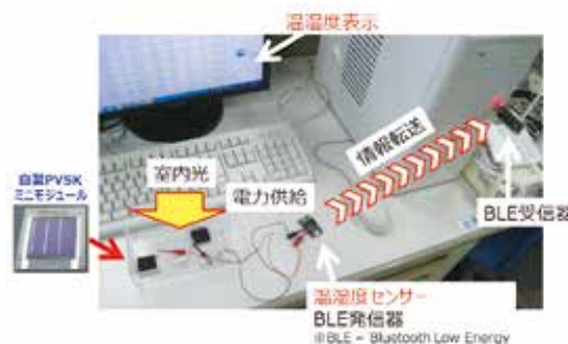
室内光独立電源を実装した温湿度センサの動作確認試験
