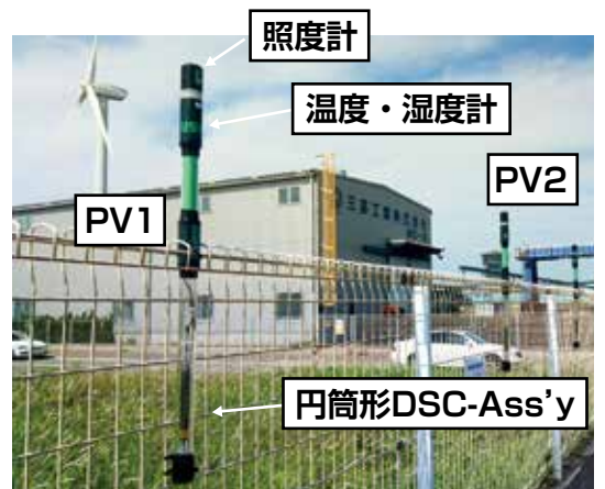
試作した円筒形太陽電池(色素増感型)の性能試験
