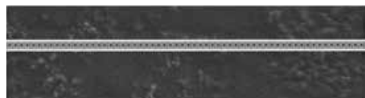
フェムト秒パルスレーザーにより直径600nmのシリカナノファイバー上に穴を作成した例
