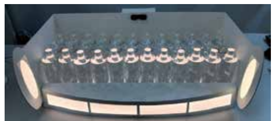
有機ELによる小型装飾照明の例 (塗布方法ではない、蒸着方式)
