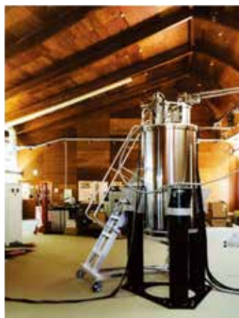
試作した 800MHz級 (18.8T) NMR装置
