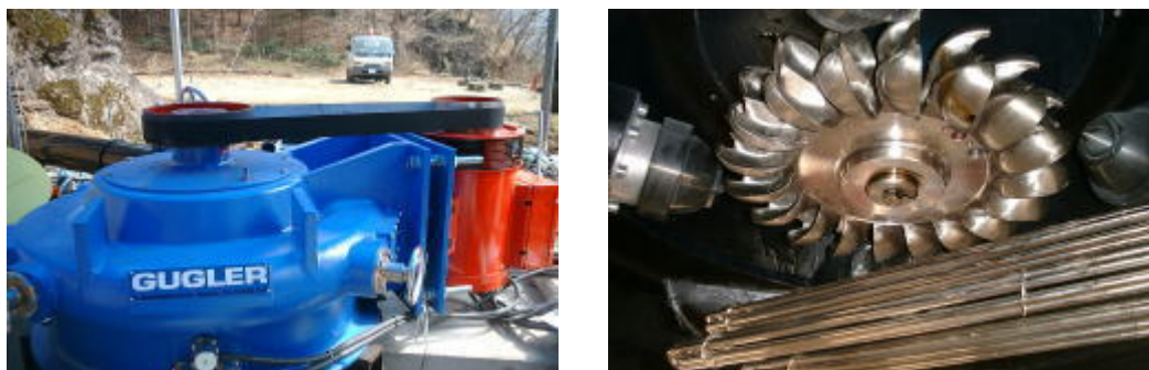
図 32 オーストラリア製のペルトン水車
