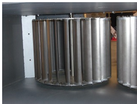
図 29 スモールハイドロストリーム (再生可能エネルギー世界フェア 2010 にて撮影)
