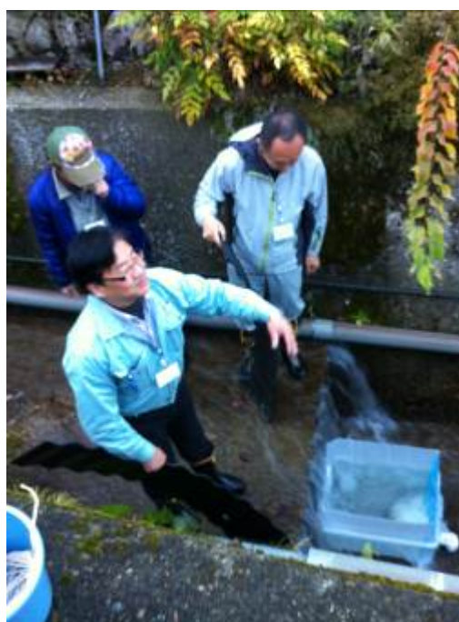
図 39 簡易な三角積を利用した計測方法について解説を行う小水力専門家
