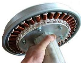
図 3-3-1-9 多極型発電機の外観。
