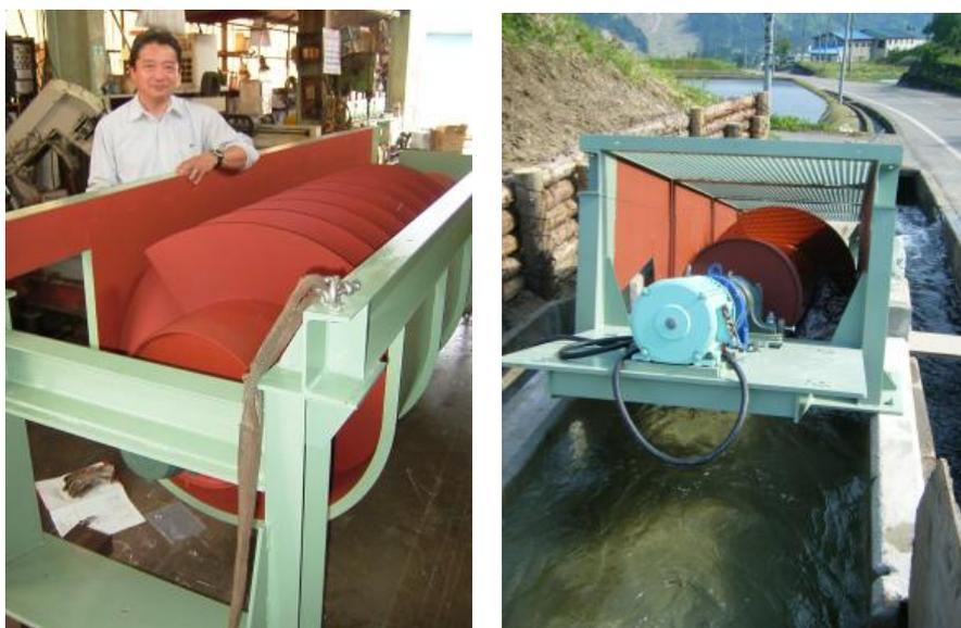
図 3-3-4-1 農業用水路用螺旋水車(2号機)の完成(左・村田製作所において)。螺旋水車の現地設置写真(841Wの出力を記録)
