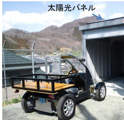
図11 動物園で運用する太陽光発電によるマイクロEVトラック
