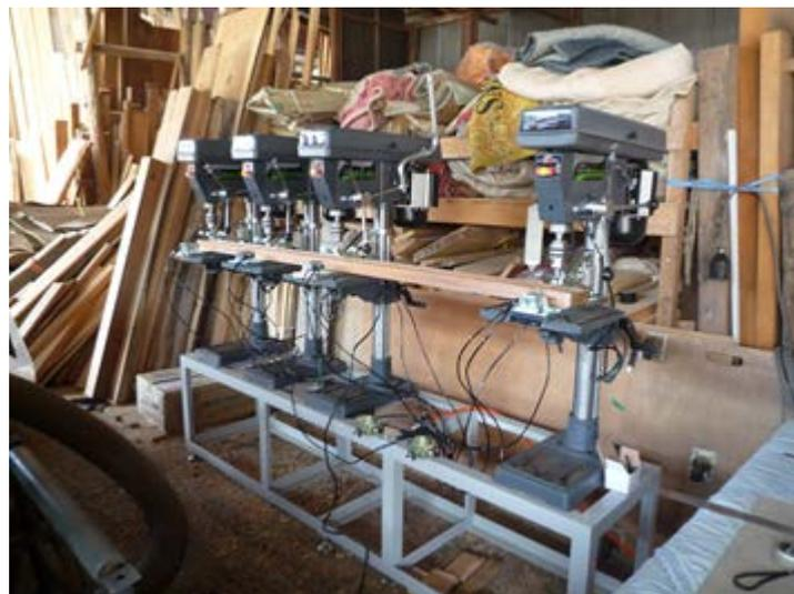
図 64 木塀用木材加工装置および治具
