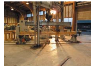
低温乾燥木材の物性試験(実大曲げ試験)の様子(名古屋大学大学院生命農学研究科)。
