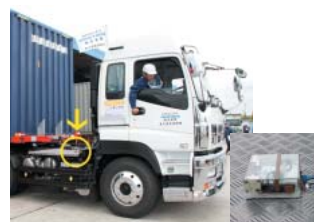
「トレーラトラック横転限界速度予測システム」のジャイロ。改良により、どんどん小さくなっています。
