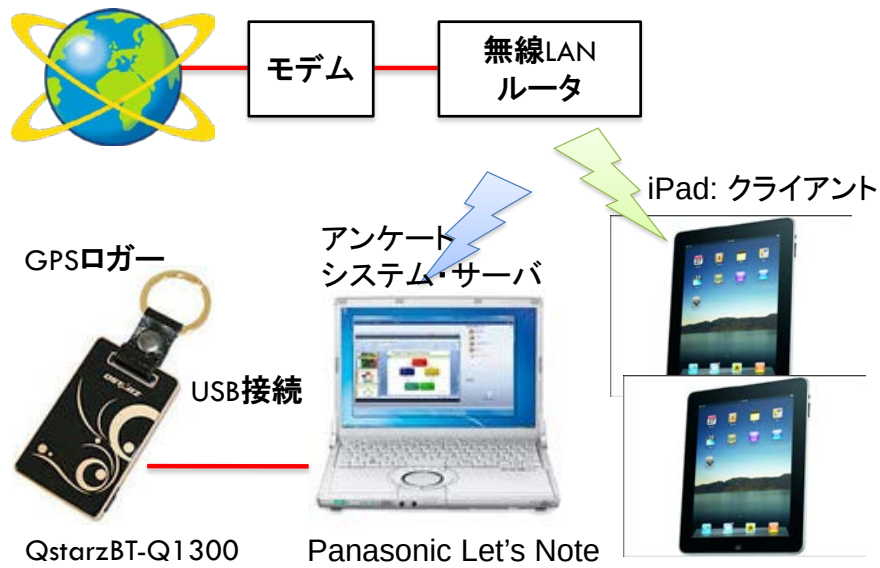
図3-3-2-1 構築したアンケートシステムの構成
