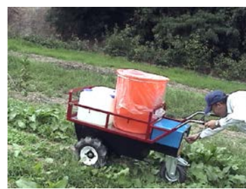
3 号機による過負荷(150kg)走行試験
