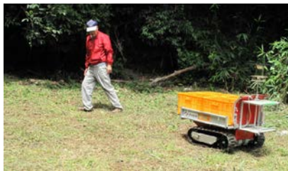
図 25. 自動追尾装置のテスト圃場での走行試験
