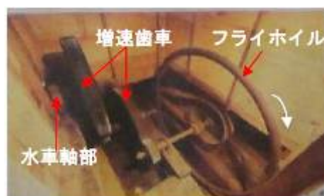
図7. 製材用木製水車におけるフライホイール取付事例（岡山県共和林業(有)様、日本経済新聞2012年4月12日）
