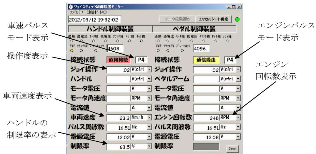
図3 ジョイスティック制御装置モニタープログラム（PC上で動作）
