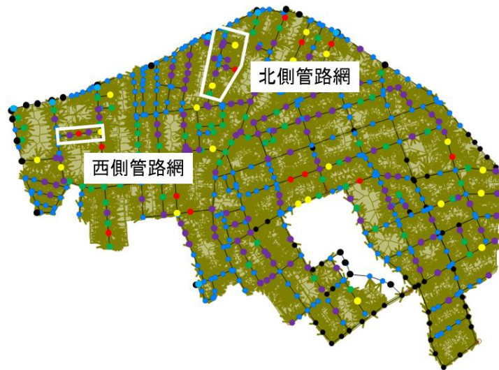
図 10 対策を実施する下水管渠網
