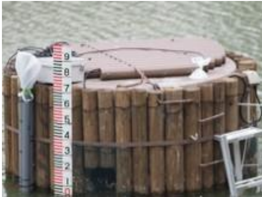
(a) 乙女が池の水位センサー設置状況 (左の塩ビパイプ内に設置) SNはボックス内
