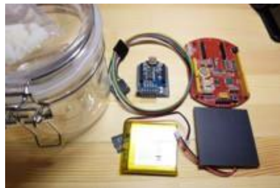
写真 6 Stalker V3防水キット (リチウムイオン電池 (中央下) とソーラパネル (右下) が見える)
