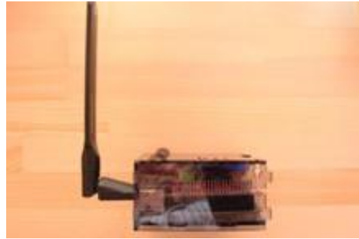
写真 9 Raspberry Pi 2にPlanex KATANAを装着した状況
