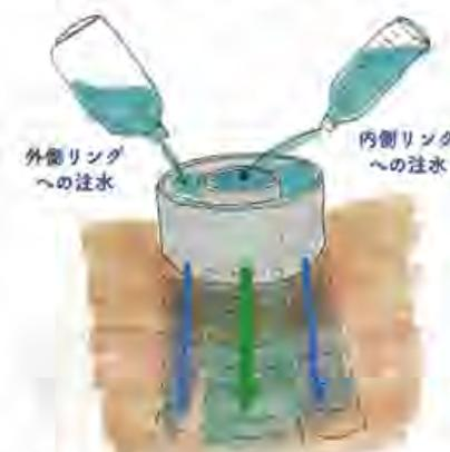
外側リングへも注水することで、できるだけ鉛直(下向き)のみに浸透させて、横向き方向に過剰に浸透しないようにしている
