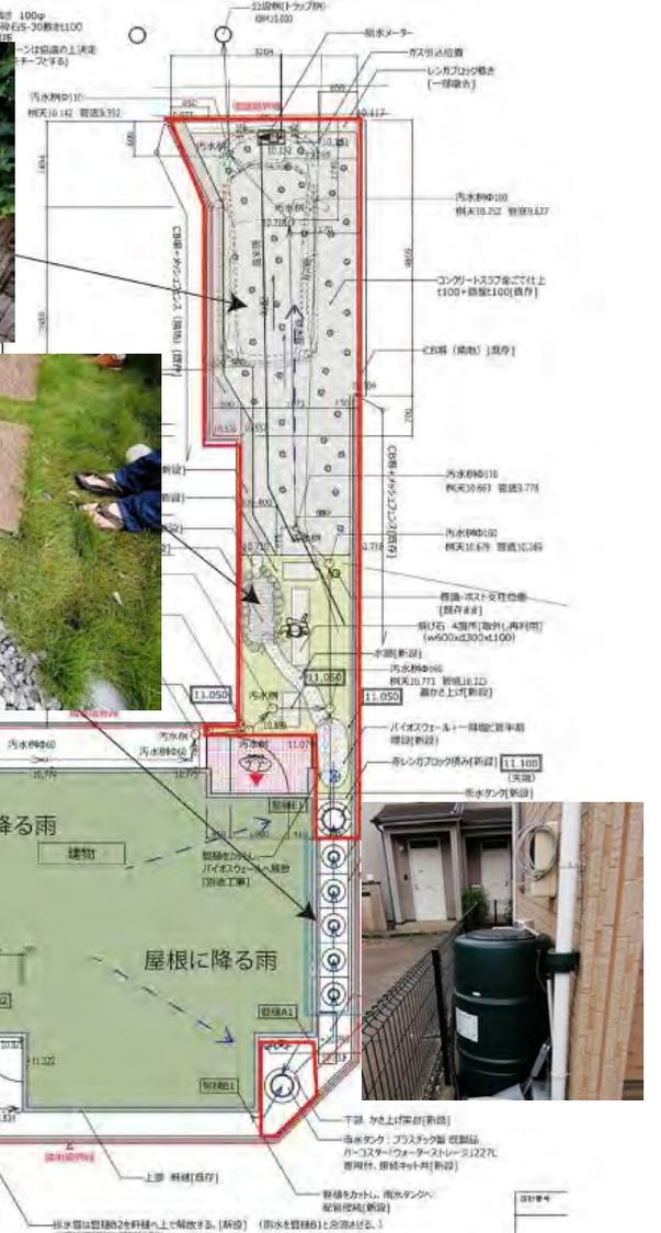
屋根に降る雨水を雨水タンクに貯留したり、バイオスウェイル（浸透型植栽スペース）へ浸透させる。
