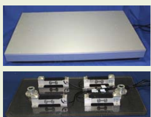
圧力計測盤の外観(上)と内部の圧力センサ(下)
