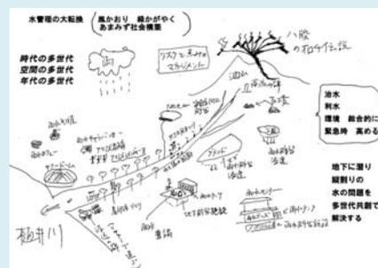
現在の水管理のサブシステムとして、分散型、自律型の雨水システムを提案する。
