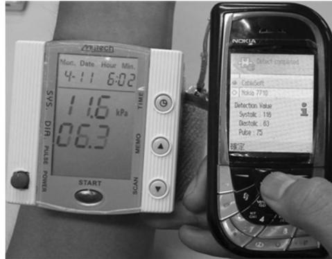
Fig. 4-4-6 腕時計型の血圧・心電計 (Lee et al. 2007より)
