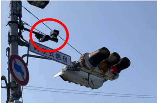
図1 対向車検知用のライダとカメラ
