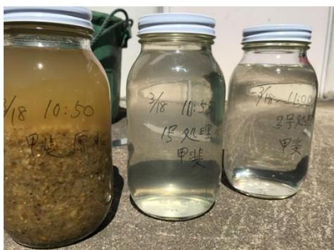
図B-4 大和自然学校の人工湿地に流入する生活排水（左）、1段目花壇式人工湿地の処理水（中）、2段目Tidal-flow人工湿地の処理水（右）
