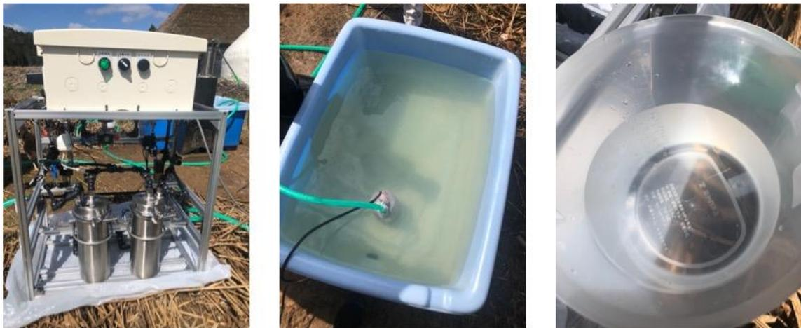
図B-2 モバイル濾過システム(左)、水源(地下水)の様子(中)、処理水の様子(右)
