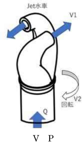
図 17 Jet 水車概念図
