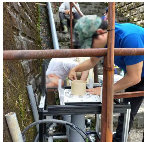
図 20 いろいろなタイプの軸受けを試す、 樹脂製は大きな外力に対してぶれる
