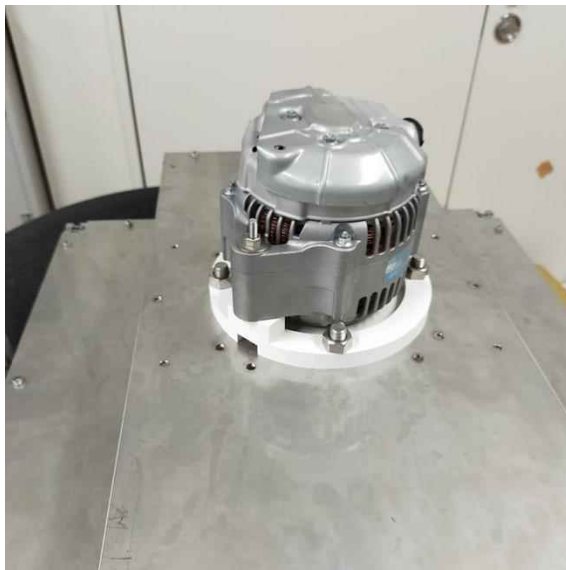
図 19 発電機を支持する台を PETG で作ったが 上向きの力に耐えきれない
