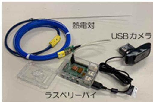
図14 開発したIoT装置
