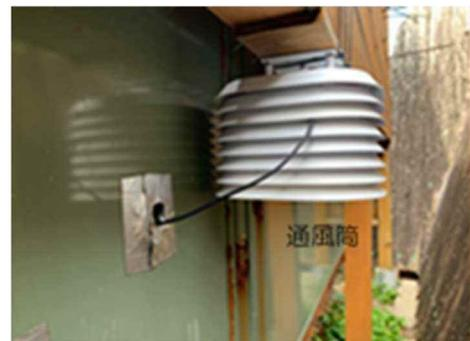
図15 通風筒を用いた大気温度測定
