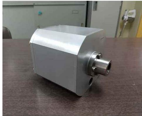
図5 スクロールCOMPRESSOR
