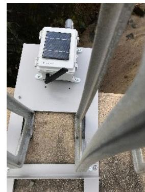
図 18 樋井川に設置した河川水位センサーの例
