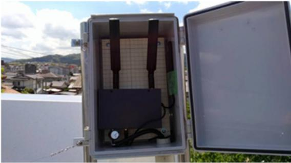
図 17 あめにお憩いセンターに設置した LoRAWAN ゲートウェイ
