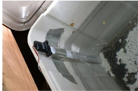
図 17 あめにお憩いセンターの雨水タンクに設置した eTape センサー
