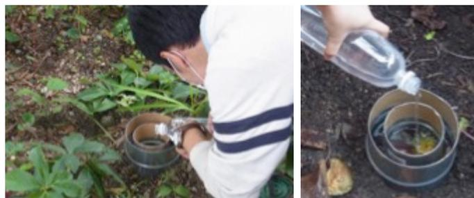
写真 2 開発した浸透試験器具
