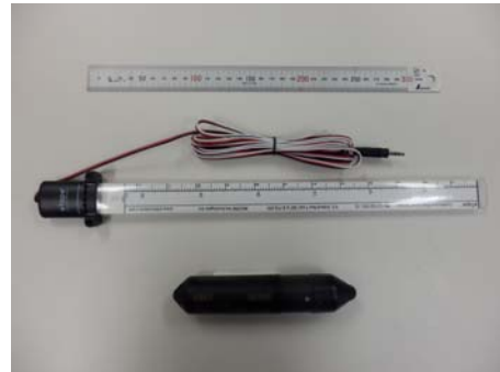
図2 水位センサー（中段：eTape liquid level sensor，下段：HOBO U20L-04，上段はスケール）
