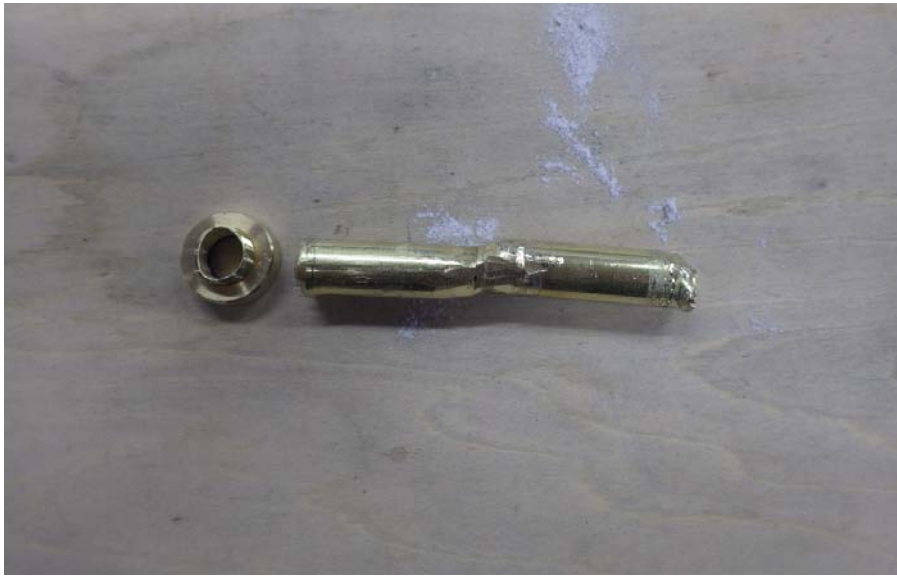
図-11 リミット型変位センサ破断状況
