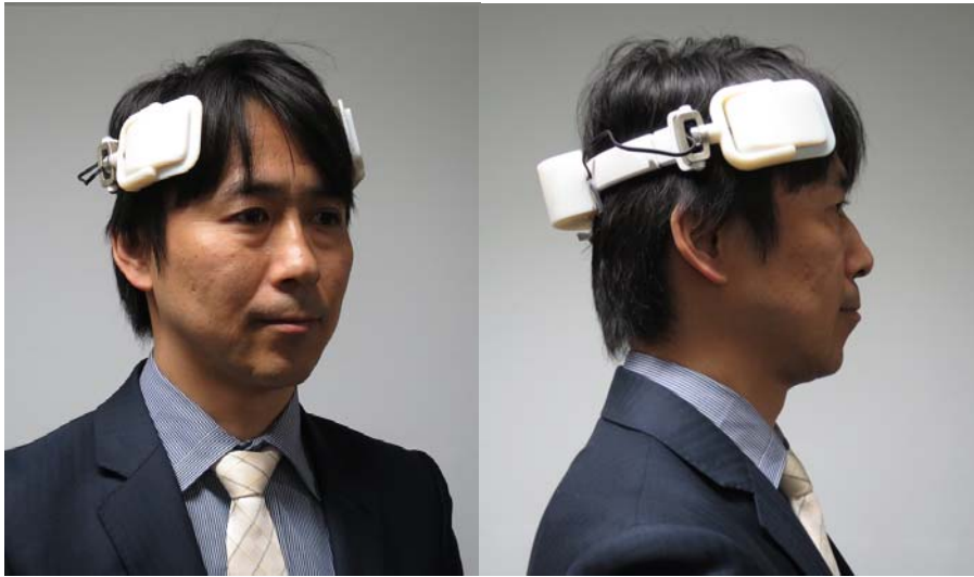
図2 スリム化された頭部装着型インターフェース
