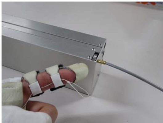
(b) ケーブルを短縮して駆動糸を指先から外した様子
