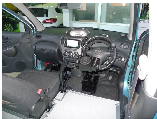
(a)運転席の様子 (b)後部乗り込み部（横開きハッチ＋スロープ） 図2．車種，トヨタファンカーゴ（普通車），全電子化（1本レバー操作）， 電動車いすを運転席として使用するタイプ
