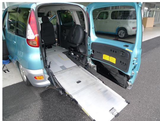
(a)運転席の様子 (b)後部乗り込み部（横開きハッチ＋スロープ） 図2．車種，トヨタファンカーゴ（普通車），全電子化（1本レバー操作）， 電動車いすを運転席として使用するタイプ
