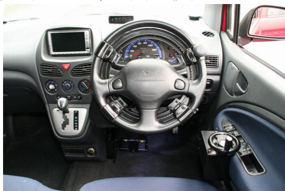
図1．車種，ダイハツMax（軽），ハンドルのみ電子化．（小径ハンドルによる操作，ハンドルは運転席側のドアに装着），運転席乗り移りタイプ
