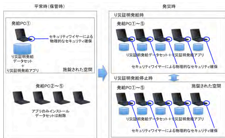
図 情報セキュリティポリシーに基づいたり災証明発給システムの管理
