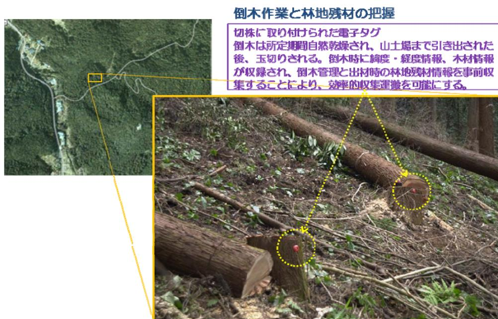
図1 林地における立木在庫情報データベースのための電子タグシステム
