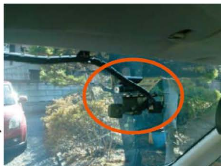
車内に設置したカメラ
