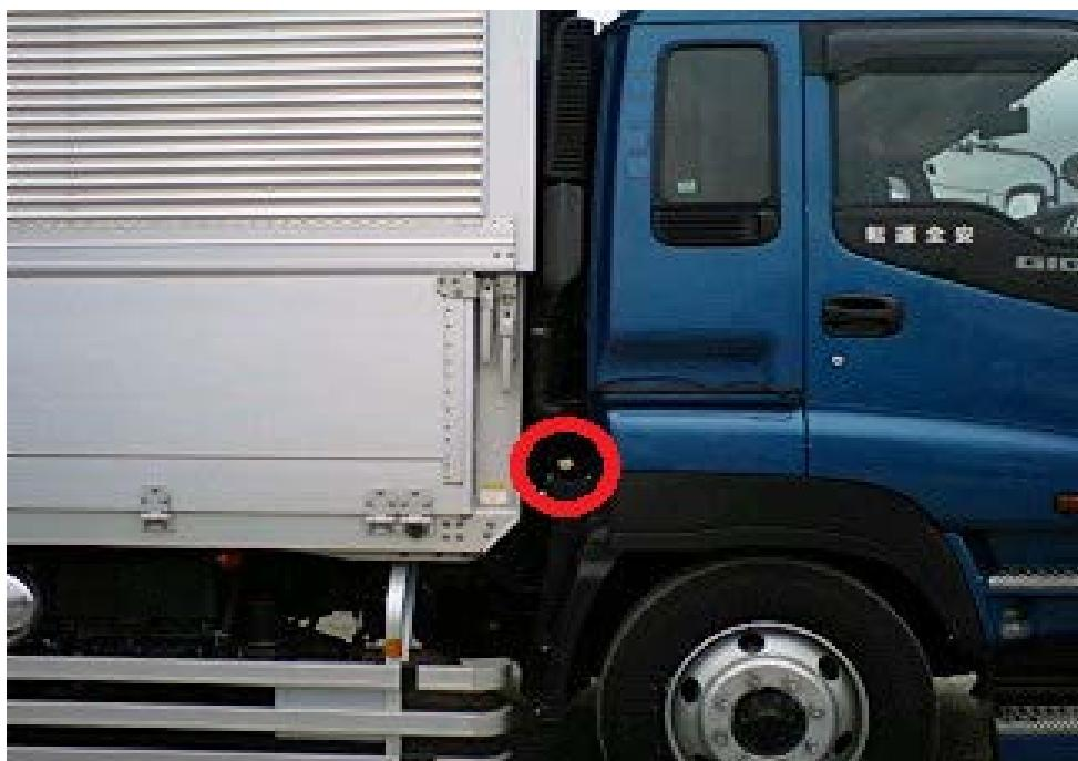
このタイプの車輌へのトレーラートラック横転防止システム搭載は初の試みとなつたため、車輌の動搖を計測するジャイロの設置位置を決めるのに少々検討時間が必要になりました。最終的には、赤丸の位置であれば問題なく動搖を計測できるとわかりました。
