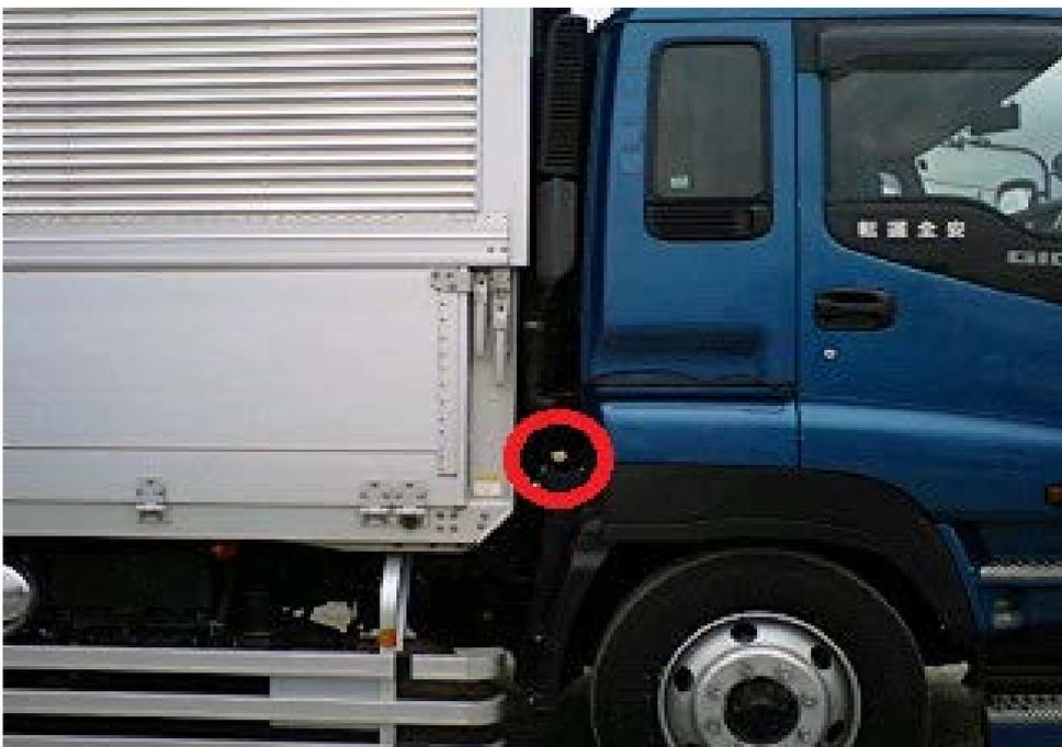
このタイプの車輻へのトレーラートラック横転防止システム搭載は初の試みとなったため、車輻の動揺を計測するジャイロの設置位置を決めるのに少々検討時間が必要になりました。最終的には、赤丸の位置であれば問題なく動揺を計測できるとわかりました。
