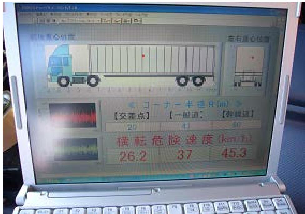
三次元重心位置(画面上部赤丸●)と横転危険速度(横転限界速度)の検知結果を、運転手に把握できるようにトレーラー社内に設置しました。第1回目の試用会では、演算部および検知結果表示部はノートPCを用いました。
