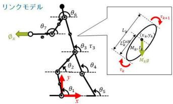
図56 シミュレーションに用いたリンクモデル
