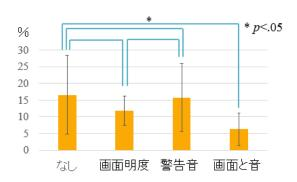
図51 固定式視線計測装置のための各視線誘導機能方式での計測不可時間の割合
