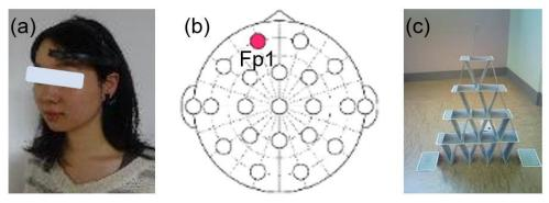
図45 (a)満足感推定法確立のために用いた脳波計測器 (b)脳波計測箇所(国際10-20法に基づくFP1) (c)トランプタワー実験風景
