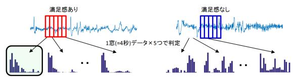
図46 主観回答と脳波成分の対応付けの概念図 (図中の1塊窓は4秒1窓x5窓=合計20秒で1塊窓を示している)
