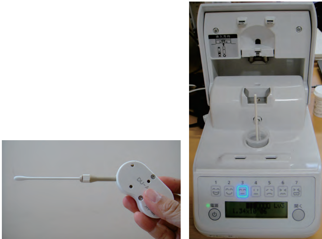
図 18：口腔内細菌測定に用いた細菌カウンタ (左：細菌採取用の綿棒を挿した定圧検体採取器具、右：細菌カウンタ本体)
