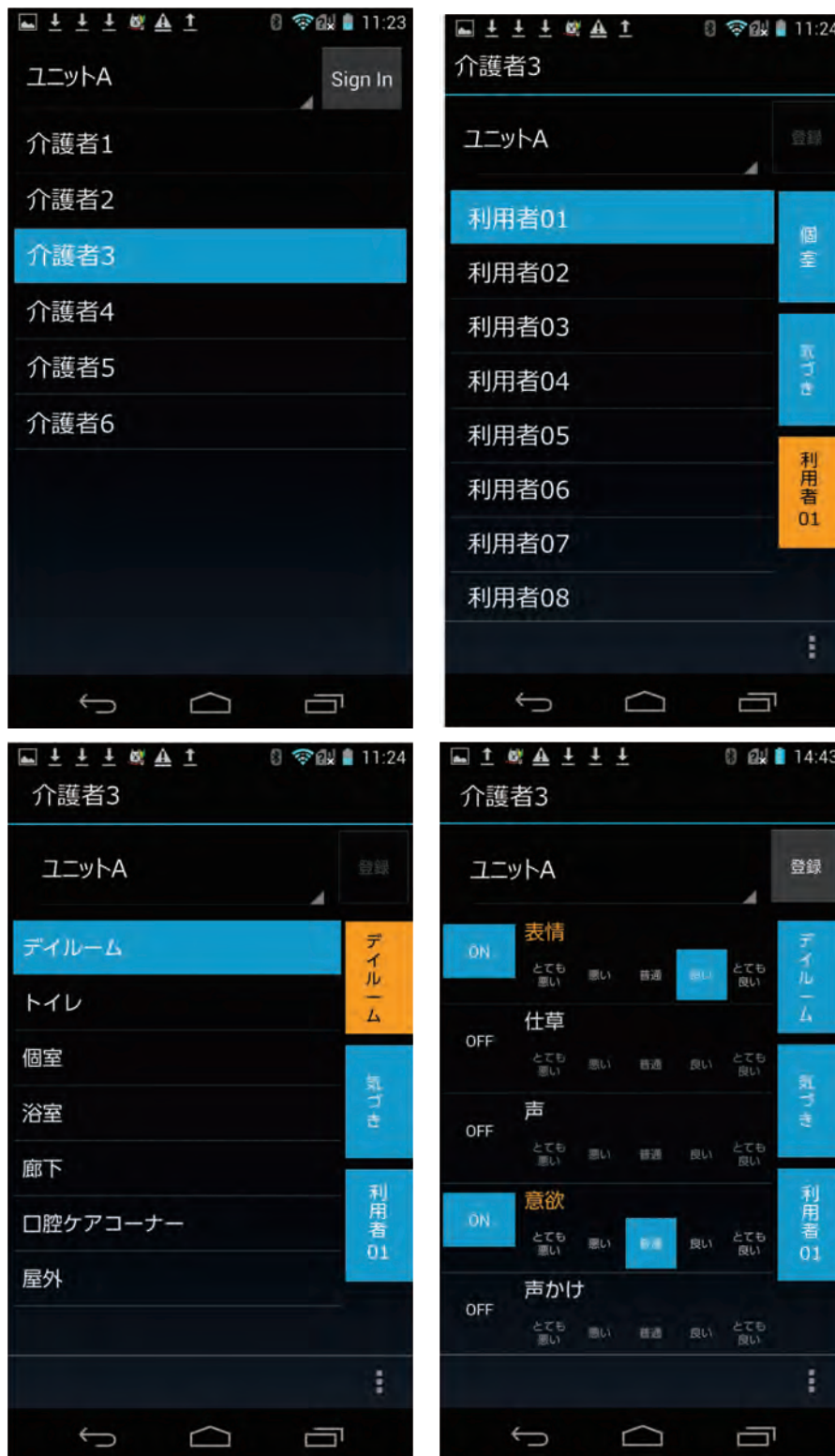
図 8：平成26年度に運用した状態把握システムの入力端末インターフェイス (左上：ユーザ選択画面、右上：利用者の選択画面、 左下：場所の選択画面、右下：項目と評価値の選択画面)
