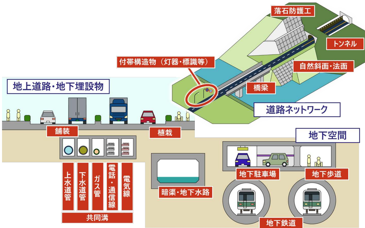
図-6 水平展開による統合的マネジメントの対象となる社会インフラ群
