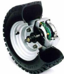
図 インホイールモーター搭載の車輪 (右：インホイールモーターの構造)
