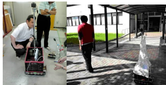
自動追尾装置の試作 赤色を認識し、その後を一定の間隔で追尾する
