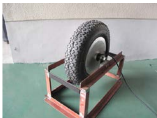
図 インホイールモーター搭載の車輪 (右：インホイールモーターの構造)
