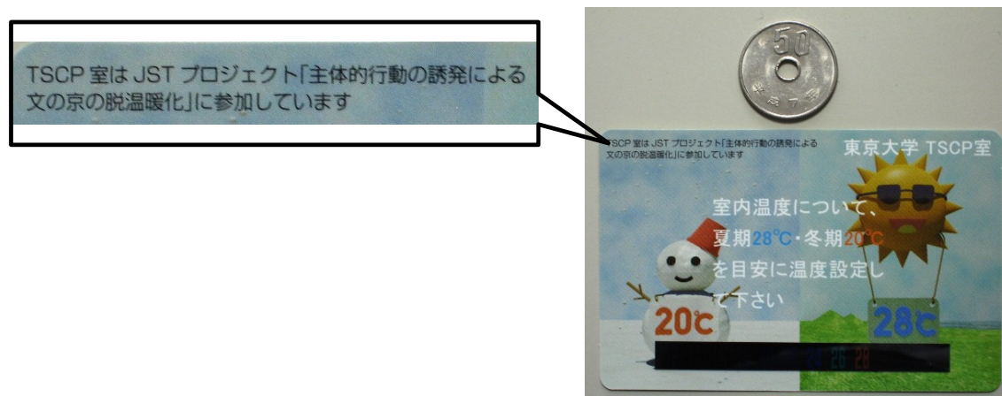
図 26 各個人の空調の設定温度管理行動を支援する感熱シール
