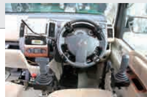
ジョイスティック2本タイプの運転システム：ハンドル操作に伴うウinker、ホーン、ブレーキロックスイッチなどの操作がジョイスティックの周辺で行えるようになっている
