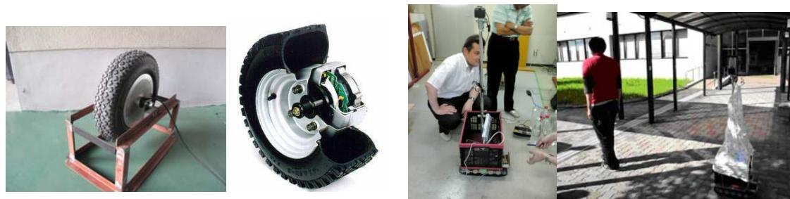
図 インホイールモーター搭載の車輪 自動追尾装置の試作
