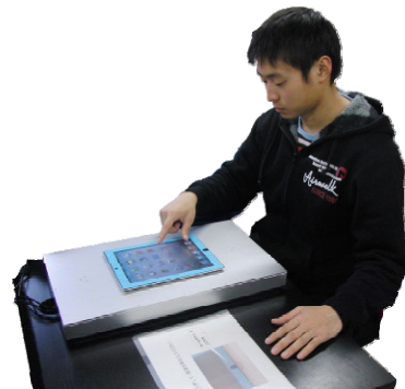
図1 新しい圧力センサ台の内部（左）と、圧力センサ台を利用したタブレット端末実験の様子（右）。
