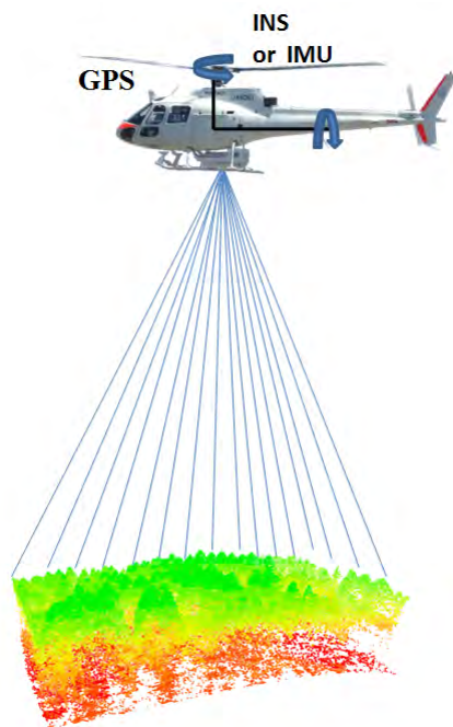
図1：航空レーザー測量による3次元レーザーリモートセンシングによる森林形状把握
