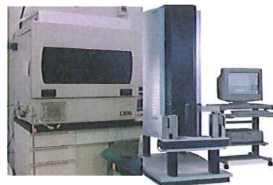
全自動糖鎖分析装置 (イメージ) (質量分析装置と SweetBlot を一体化)
