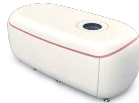
■図1 リングエコーの製品イメージ(左)。受診者がうつぶせになり、穴に乳房を入れるとリング型の超音波振動子が上下に動き、自動的に3次元で撮像する。乳房の形状を変えず自然な状態なので、再現性の高い画像を撮れる。
