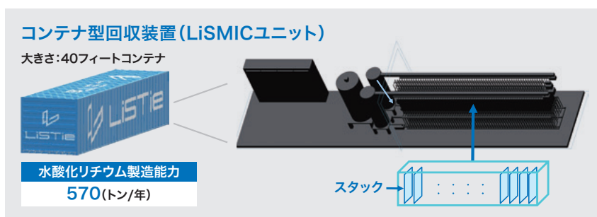
図2 一般的に流通しているコンテナと同じ40フィートサイズ内に、多数のセラミックス膜を装着した分離装置が収められている。運搬した後、そのまま現地で運用できる設計だ。
