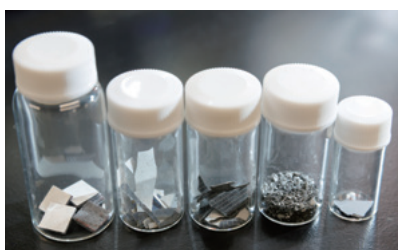
図1 シリコンのサンプル。実際に太陽光パネルから取り出したものはさまざまな形状をとり、目に見える不純物もあれば、原子レベルの不純物もある。
