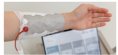
図2 システムは、接触を検知するセンサーシートとタブレットのセットで構成される。使用する際は患者の点滴刺入部に包帯を巻き、その上にシートを貼り付ける。
