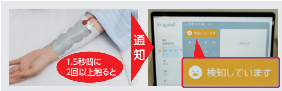
図3 センサーシートには2つの回路が張り巡らされていて、同時に触れると接触を検知し、通知を送信するようになっている。検知時の警告音は、他の医療機器で鳴るアラームや心電図の音と混同しないように音の高さなどを工夫している。また、検知時の病室の画像も表示可能で、看護師がすぐに病室に駆け付ける必要があるかどうか、タブレット上で確認できる。
